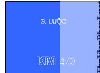
Hình 76: Báo hiệu báo cây số đường thủy nội địa (C4.11)
